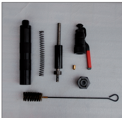
Plocka isär och rengör bultpistolen efter användning. Delarna är från vänster: pistolhylsa, fjäder, avlivningspik, pistolhuvud med avtryckare och slagbult, ammunition, förslutningskruv och rengöringsborste. Foto: Håkan Areslätt
